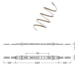
Technische Daten Ledvance LED-Streifen Value 1500 60W 5640lm 24v - 827 | 5M/8mm
